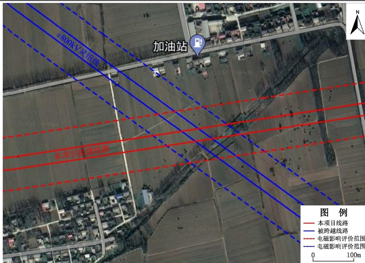
图 6-22 与±800kV 灵绍线交叉跨越处
